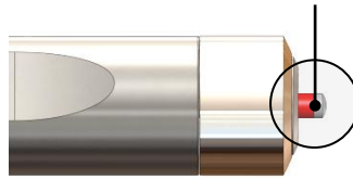
Zündstift gesichert Sicherungshebel aktiv
